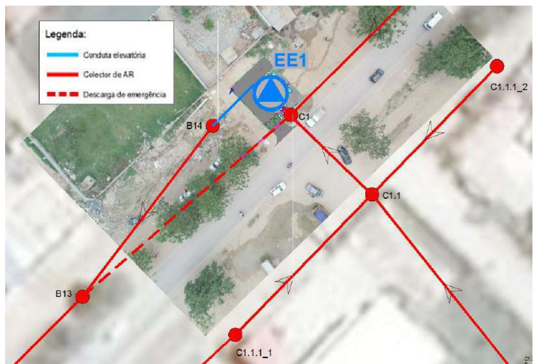
Figura 4.7 - Representação da solução de descarga de emergência da EE1, com colector de emergência de C1 a B13.
