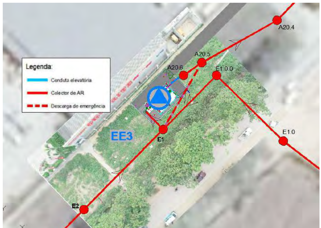
Figura 4.9 - Representação da solução de descarga de emergência da EE3, com coletor de emergência E1 a A20.5.
