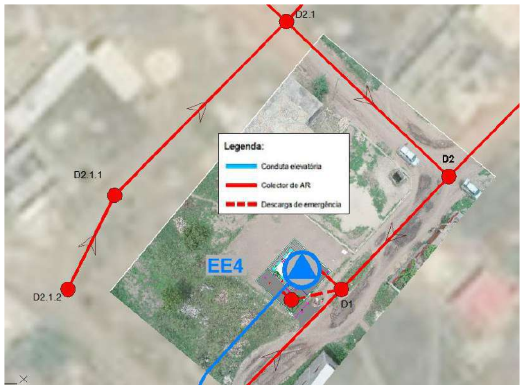
Figura 4.10 - Representação da solução de descarga de emergência para a EE4, com colector de emergência desde a caixa D1 até à conduta elevatória.
