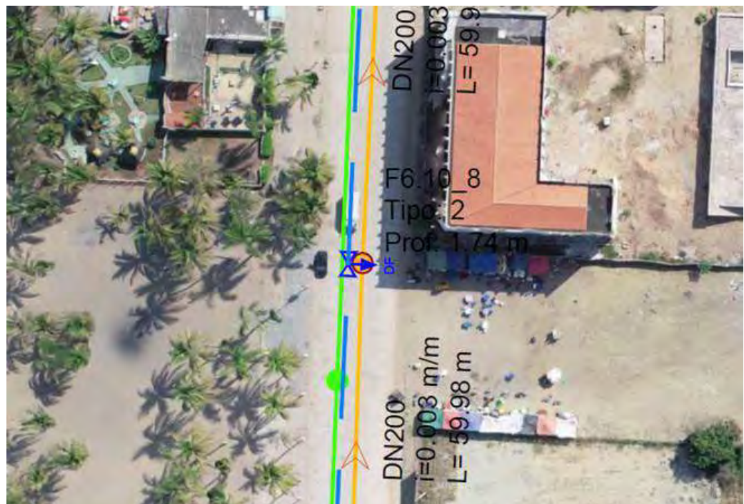
Figura 4.17 – Ligação da descarga de fundo da CE5 à rede
