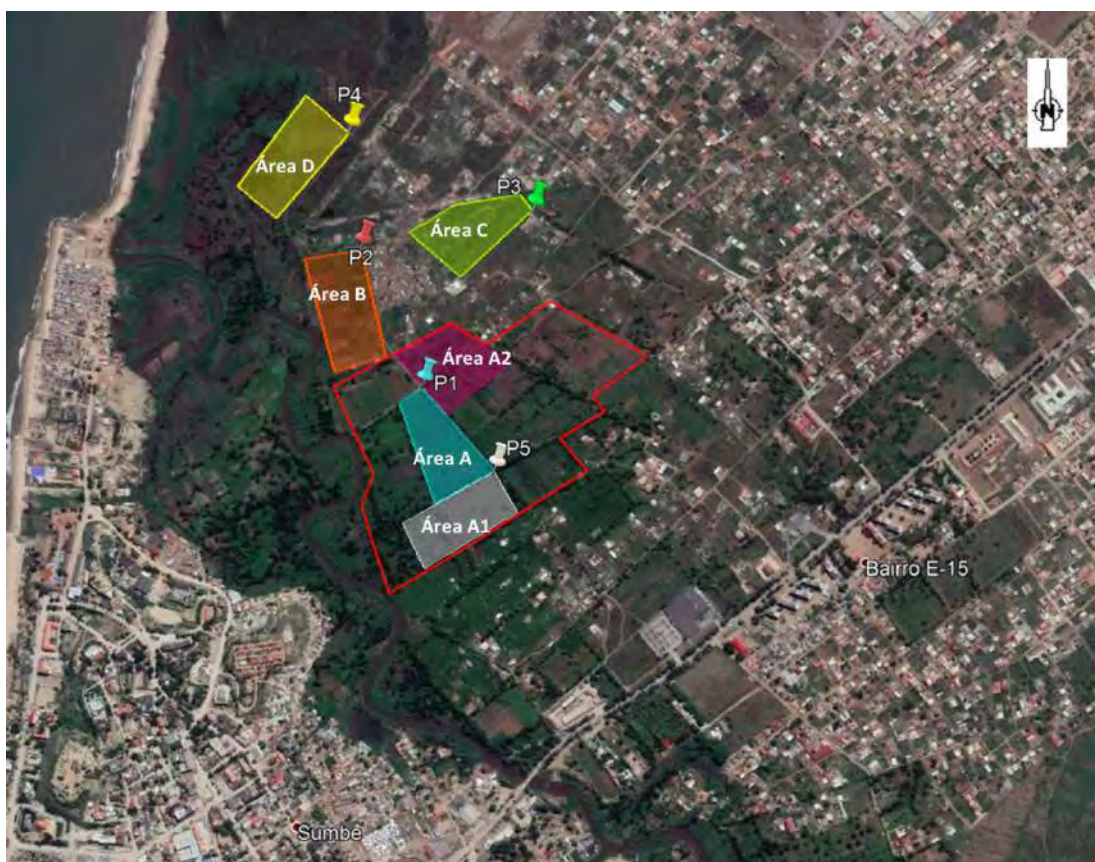
Figura 4.2 - Localização das áreas alternativas de implantação da ETAR e limite de zona agrícola fértil organizada (limite a cor vermelha); P2 (M: 373 548.00 E; P: 8 763 078.00 S.), P3 (M: 373 961.00 E; P: 8 763 214.00 S), P4 (M: 373 490.00 E; P: 8 763 363.00 S) e P5 (M: 373 931.00 E; P: 8 762 567.00 S).
